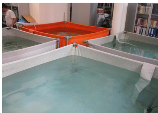
Prova di carico su una volta
